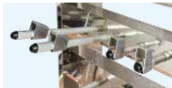
選べる吹出しノズル 左：長靴用ノズル、右：短靴用ノズル ※10足単位での販売
